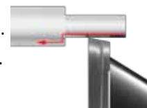
Kleiner axialer Freiwinkel -Stabile Schneide
